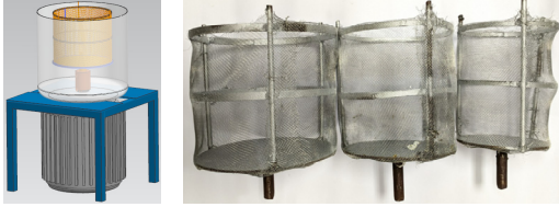
Hình 3. Mô hình thực nghiệm việc chiết nước chanh dây và các lồng xoay
